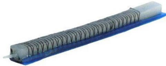
(b) PneuFlex actuator
